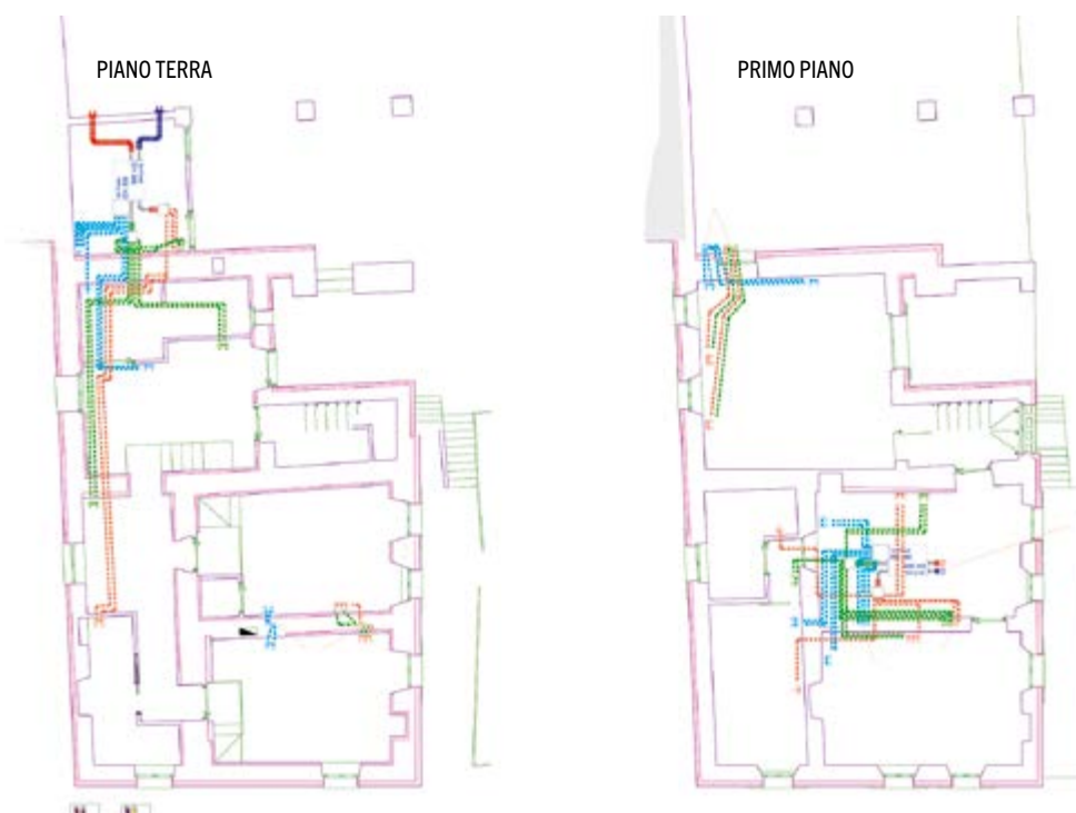
Fig.5 Layout dei circuiti di un sistema con VMC utilizzata anche come sistema deumidificante. I due piani dell'edificio sono climatizzati tramite pavimento radiante, mentre le due unità VMC, una disposta nel locale tecnico e l'altra nel sottotetto, si occupano di assicurare il ricambio dell'aria esterna e controllare il processo di deumidificazione estiva (Studio Ing. L. Ferrari – Cappellotto by Henco)
